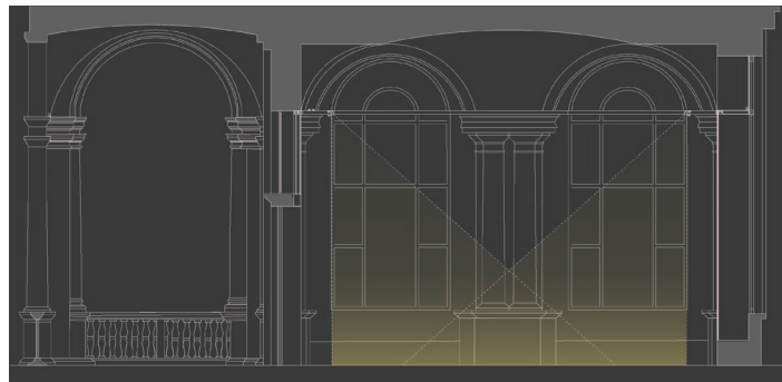
Gli apparecchi lineari asimmetrici, con una lente che riduce i valori di UGR (nessun abbagliamento molesto), "lavano" il piano orizzontale della platea.
