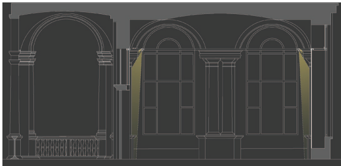
Un profilo lineare a sezione circolare con strip led rigida illumina la trabeazione. Un piccolo proiettore con lente a fascio stretto "pennella" la colonna.
